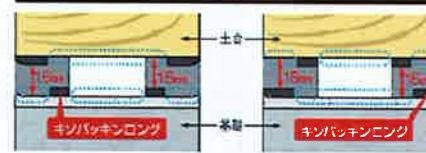
できる多くの開口部を取ることで換気性能を高め、土台の隙間に防ぎます。
